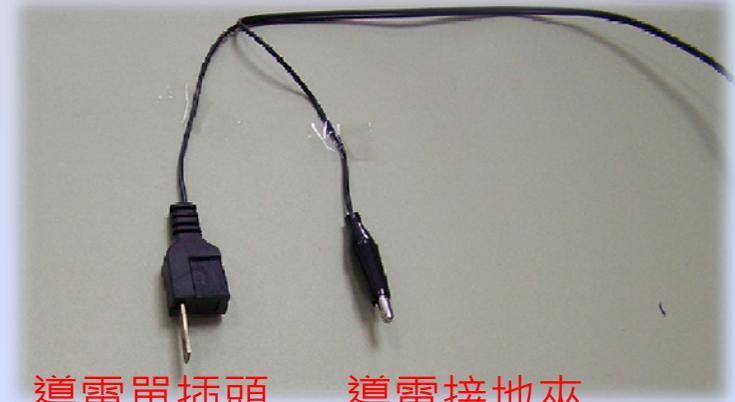
導電單插頭      導電接地夾
