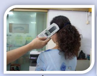
離影印機約一米半距離, 人體腦部電磁波量測值達 17V/m
