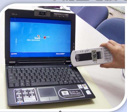
筆電開機狀態,未使用新芳奈米輻射除轉墊及 抗電磁波裝置,電磁波量測值高達464 V/m
